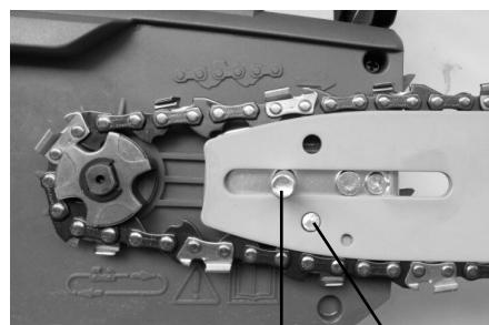
PERNO DE GUÍA      PERNO DE TENSION
