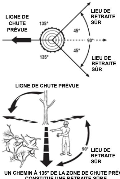
Avant de commencer l'abattage, prenez en compte la force et la direction du vent, l'inclinaison et l'équilibre de l'arbre et l'emplacement des grosses branches. Ces facteurs influencent la direction de la chute de l'arbre. N'essayez pas d'abattre un arbre sur une zone différente de sa zone de chute naturelle.
