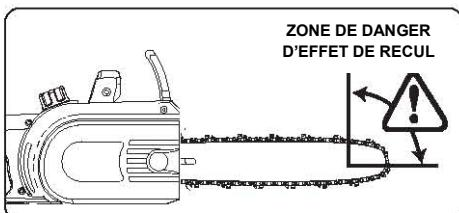
**AVERTISSEMENT :** n'utilisez pas la tronçonneuse avec n'importe quel type d'accessoire ou d'outil. Une telle utilisation pourrait être dangereuse.
