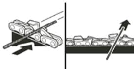
Relevez la lime de l'acier à chaque retour de celle-ci. Effectuez quelques coups fermes sur chaque dent. Affûtez toutes les gouges de gauche dans un sens. Passez ensuite à l'autre côté et affûtez les gouges de droite dans le sens contraire. De temps en temps, retirez la limaille de la lime à l'aide d'une brosse métallique.
