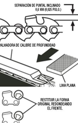
Los calibres de profundidad se deben ajustar con la lima plana en la misma dirección en que se afiló la cuchilla contigua con la lima redonda. Tenga la precaución de no tocar la cara de la cuchilla con la lima plana al ajustar los calibres de profundidad.
