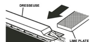
Utilisez une lime plate et une dresseuse pour abaisser tous les limiteurs de façon uniforme. Des dresseuses sont disponibles en 0,5 mm à 0,9 mm (0,020 po. à 0,035 po.). Utilisez une dresseuse de 0,6 mm (0,025 po.). Après l'abaissement de chaque
