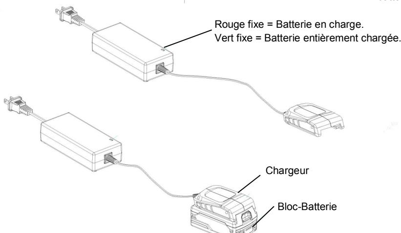
INSTALLATION ET DÉPOSE DE LA BATTERIE
