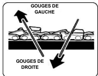
**AVERTISSEMENT :** un mauvais affûtage de la chaîne augmente la possibilité d'un effet de recul.
