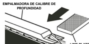
Los calibres de profundidad se deben ajustar con la lima plana en la misma dirección en que se afiló la cuchilla contigua con la lima redonda. Tenga la precaución de no tocar la cara de la cuchilla con la lima plana al ajustar los calibres de profundidad.
