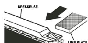
Les limiteurs de profondeurs doivent être réglés avec la lime plate dans le même sens que celui d'affûtage avec la lime ronde de la gouge adjacente. la lime plate ne touche pas la face des gouges lors de l'ajustement des limiteurs de profondeur.
