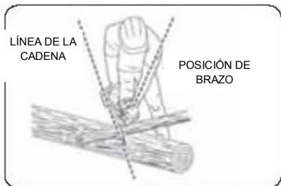
Apriete el gatillo y permita que la cadena acelere hasta la velocidad máxima antes de comenzar a cortar.
