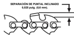
Después de limar la cadena, compruebe la separación del calibre de profundidad.
