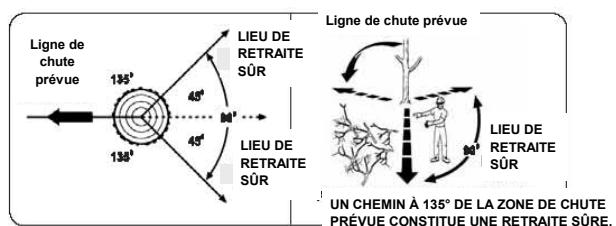
Avant de commencer l'abattage, prenez en compte la force et la direction du vent, l'inclinaison et l'équilibre de l'arbre et l'emplacement des grosses branches. Ces facteurs influencent la direction de la chute de l'arbre. N'essayez pas d'abattre un arbre sur une zone différente de sa zone de chute naturelle.
