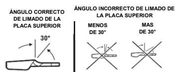
Inclinación hacia atrás: necesita demasiada presión de alimentación, causa un desgaste excesivo a la barra y cadena. Esto se produce al usar una lima de un diámetro demasiado grande o que se sostiene en una posición muy alta.
