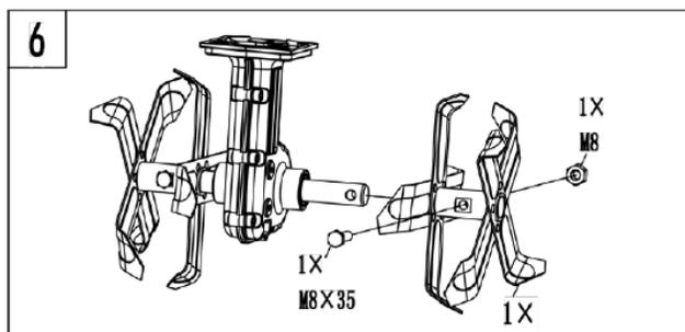
Remplacez les pièces usées ou endommagées uniquement par des pièces d'origine. Les pièces d'un autre cultivateur/griffe pourraient ne pas s'ajuster correctement et poser des risques.
