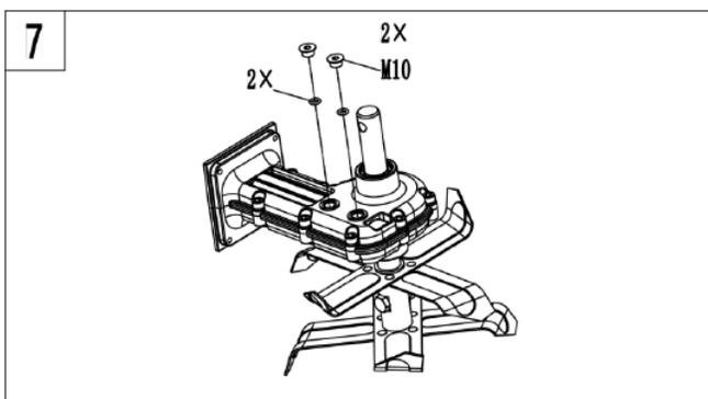
Les bouchons à vis de vidange se trouvent sur le côté droit du carter de transmission. Penchez le cultivateur/la griffe sur son côté gauche et nettoyez la saleté et les débris de la transmission avant d'enlever les bouchons à vis de vidange. Si nécessaire, enlevez les ensembles de dents pour faciliter l'accès aux bouchons à vis de vidange. Utilisez une clé hexagonale de 5 mm pour dévisser les bouchons.
