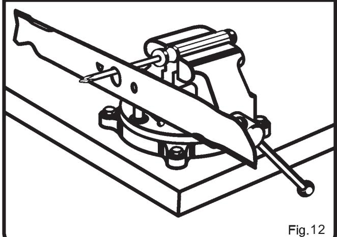
Si la lame est en équilibre, elle reste en position horizontale. Si une extrémité de la lame penche vers le bas, affûtez le côté lourd jusqu'à ce que la lame retrouve l'équilibre.
