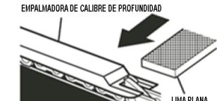
Utilice una lima plana y una empalmadora para bajar todos los calibres de manera uniforme. Existen en el mercado empalmadoras de calibre de profundidad de 0,5 mm a 0,9 mm (0,020 a 0,035 pulg.). Utilice una empalmadora de 0,6 mm (0,025 pulg.).
