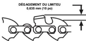
Utilisez une lime plate et une dresseuse pour abaisser tous les limiteurs de façon uniforme. Des dresseuses sont disponibles en 0,5 mm à 0,9 mm
