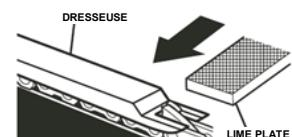
Les limiteurs de profondeurs doivent être réglés avec la lime plate dans le même sens que celui d'affûtage avec la lime ronde de la gouge adjacente. La lime plate ne touche pas la face des gouges lors de l'ajustement des limiteurs de profondeur.
