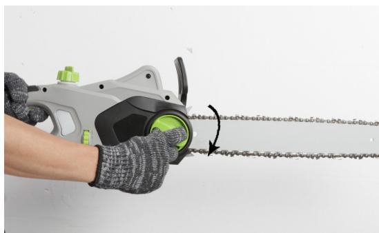
La cadena tendrá la tensión correcta si no hay comba en la parte inferior de la barra guía y la cadena está ajustada pero se puede girar a mano sin que se trabé.
