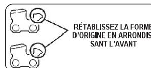
Les limiteurs de profondeurs doivent être réglés avec la lime plate dans le même sens que celui d'affûtage avec la lime ronde de la gouge adjacente. la lime plate ne touche pas la face des gouges lors de l'ajustement des limiteurs de profondeur.
