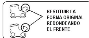
Los calibres de profundidad se deben ajustar con la lima plana en la misma dirección en que se afiló la cuchilla contigua con la lima redonda. Tenga la precaución de no tocar la cara de la cuchilla con la lima plana al ajustar los calibres de profundidad.
