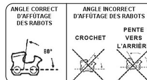
Crochet – « Accroche » et s'érouse rapidement. Augmente le potentiel d'effet de recul. Résulte de l'utilisation d'une lime d'un diamètre trop petit ou si la lime est tenue trop bas.
