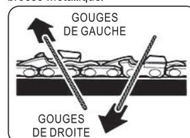
**AVERTISSEMENT** : un mauvais affûtage de la chaîne augmente la possibilité d'un effet de recul.
