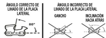
Inclinación hacia atrás: necesita demasiada presión de alimentación, causa un desgaste excesivo a la barra y cadena. Esto se produce al usar una lima de un diámetro demasiado grande o que se sostiene en una posición muy alta.
