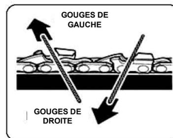
**AVERTISSEMENT :** un mauvais affûtage de la chaîne augmente la possibilité d'un effet de recul.
