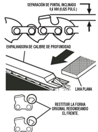
Los calibres de profundidad se deben ajustar con la lima plana en la misma dirección en que se afiló la cuchilla contigua con la lima redonda. Tenga la precaución de no tocar la cara de la cuchilla con la lima plana al ajustar los calibres de profundidad.
