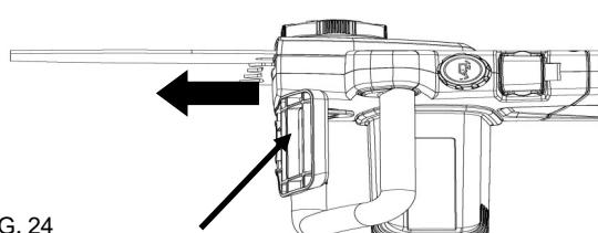
**PRECAUCIÓN:** La falta de lubricación de la cadena provocará daños a la barra y la cadena. Use únicamente un aceite de buena calidad para la barra y la cadena, si no hubiera, lo puede reemplazar por aceite de motor de viscosidad SAE 30. El consumo aproximado de aceite durante un minuto de uso es de 0,15 onzas líquidas (5 ml).
