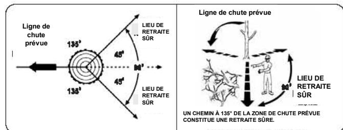
Avant de commencer l'abattage, prenez en compte la force et la direction du vent, l'inclinaison et l'équilibre de l'arbre et l'emplacement des grosses branches. Ces facteurs influencent la direction de la chute de l'arbre. N'essayez pas d'abattre un arbre sur une zone différente de sa zone de chute naturelle.
