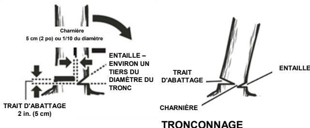
Tronçonnage et le terme utilisé pour la découpe d'un arbre abattu en billots de la longueur souhaitée.
