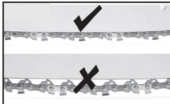
**NOTA:** Si la cadena está demasiado ajustada, no podrá desplazarse. Afloje levemente la perilla y gire el tensor de la cadena 1/4 de vuelta hacia la izquierda. Levante la punta de la barra guía y vuelva a apretar la perilla. Asegúrese de que la cadena gire sin trabarse.
