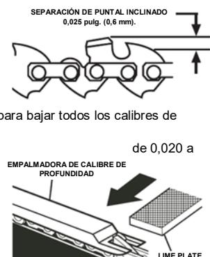
Los calibres de profundidad se deben ajustar con la lima plana en la misma dirección en que se afiló la cuchilla contigua con la lima redonda. Tenga la precaución de no tocar la cara de la cuchilla con la lima plana al ajustar los calibres de profundidad.
