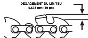
Utilisez une lime plate et une dresseuse pour abaisser tous les limiteurs de façon uniforme. Des dresseuses sont disponibles en 0,5 mm à 0,9 mm (0,020 po. à 0,035 po.). Utilisez une dresseuse de 0,6 mm (0,025 po.). Après l'abaissement de chaque limiteur de profondeur, rétablissez la forme d'origine en arrondissant l'avant. Veillez à ne pas endommager les maillons d'entraînement adjacents avec le bord de la lime.
