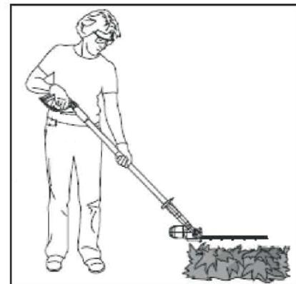
**PRECAUCIÓN:** No utilice el cortasetos para cortar tallos de más de 16 mm (5/8 pulg). Úselo únicamente para cortar arbustos que se encuentran alrededor de casa y edificios.
