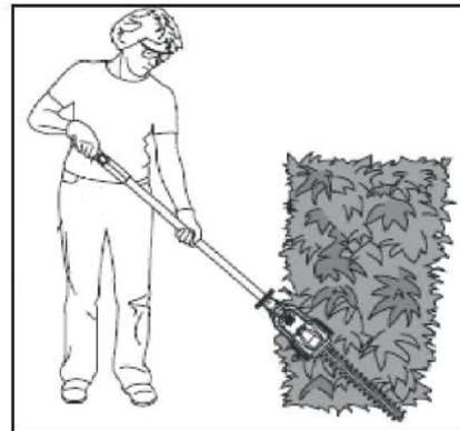
Para usar el cortasetos telescópico para cortar follaje bajo o cubresuelos, sosténgalo en la posición que muestra la figura.
