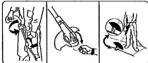
Pour remettre l'outil en position de coupe, arrêtez-le, poussez dans le sens de la flèche et faites tourner la tête de la tondeuse à fil dans le sens contraire des aiguilles d'une montre jusqu'à ce qu'elle s'arrête. Lors de l'utilisation de l'outil en mode tondeuse à fil, vous pouvez choisir de plier le guide du fil hors de la trajectoire.
