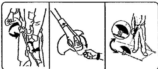
Si desea volver a la posición de desbrozadora, apague la herramienta, presione en la dirección de la flecha y gire el cabezal en el sentido contrario a las agujas del reloj hasta que se detenga. Cuando usa la herramienta en el modo de desbrozadora, puede elegir plegar la guía de borde hacia arriba para que no estorbe.
