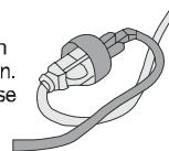
**NE PAS TIRER SUR LE CÂBLE D'ALIMENTATION** – Ne portez jamais la tondeuse à fil par le câble d'alimentation et ne tirez jamais celui-ci pour le débrancher. Maintenez le câble à l'écart de la chaleur, de l'huile et des bords tranchants.
