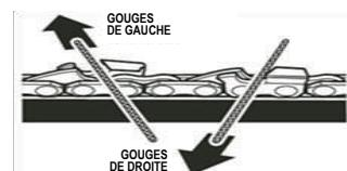
**AVERTISSEMENT :** un mauvais affûtage de la chaîne augmente la possibilité d'un effet de recul.
