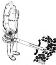
Sostenga el tubo de soplado a una altura aproximada de 18 cm (7 pulg.) del suelo, encienda el producto y avance lentamente con un movimiento de barrido de lado a lado. Mantenga la acumulación de desechos y hojas delante de usted.
