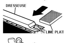
Les limiteurs de profondeurs doivent être réglés avec la lime plate dans le même sens que celui d'affûtage avec la lime ronde de la gouge adjacente, la lime plate ne touche pas la face des gouges lors de l'ajustement des limiteurs de profondeur.
