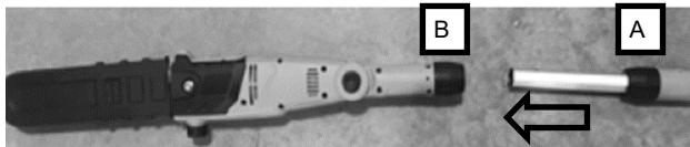
2. Afloje el acoplamiento del eje B girándolo hacia la izquierda.
