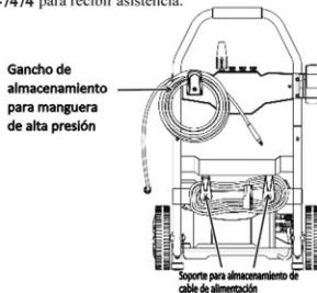
\* El soporte inferior izquierdo que ayuda a asegurar el cable de alimentación se puede girar hacia la derecha para permitir una extracción más fácil del cable.
