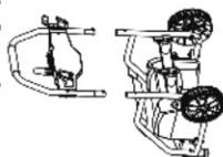
Introduisez la poignée supérieure dans celle du bas tout en appuyant sur le bouton de verrouillage. Poussez fermement la poignée vers le bas jusqu'à ce que le bouton de verrouillage s'enclenche en place.
