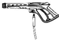
Introduzca la manguera de alta presión directamente en el mango de la pistola y asegúrese de que esté conectado firmemente. Presione el botón para que salga la manguera y haga fuerza hacia abajo de la manguera para desconectarla.
