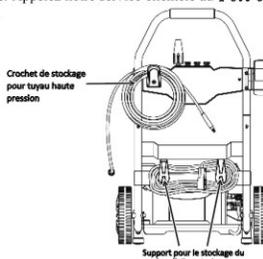
\* Le support inférieur gauche qui permet de sécuriser le cordon d'alimentation peut être tourné vers la droite pour faciliter le retrait du cordon.
