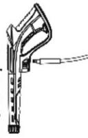
Coloque la lanza de pulverizado en el mango de la pistola. Rote 1/4 de giro para que caíste en su posición.
