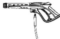
Insérez le tuyau haute pression directement dans la poignée du pistolet et assurez-vous que la connexion est étanche. Poussez sur le bouton de débranchement du tuyau et tirez le tuyau vers le bas pour le déconnecter.
