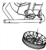
Insérez l'axe de roue à travers le trou sur le centre de la roue inférieure. Fixez l'essieu en place avec la goupille fendue fournie.
