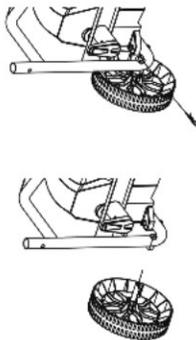
Inserte el eje de la rueda a través del orificio en el marco inferior de la lavadora. Asegure el eje en su lugar con el pasador de chaveta provisto.
