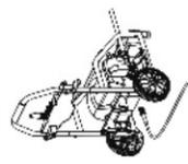
Fixez correctement le tuyau d'arrosage au raccord de l'entrée d'eau
